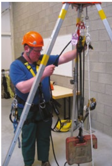
Formation // Descente dans un pompage sécurisée par matériel antichute et agent de surveillance
