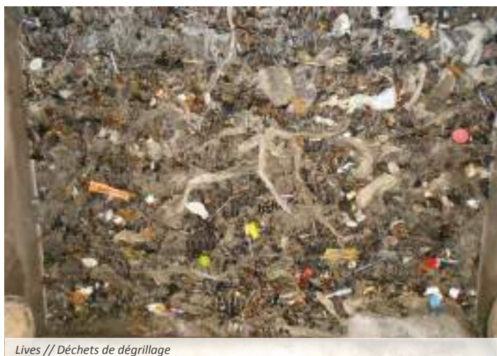
Lives // Déchets de dégrillage
